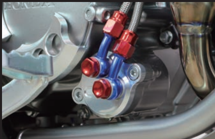
装着写真(オイル取り出し口)
