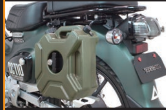
タンク装着写真 スーパーカブ110(JA59) SP武川サイドバッグサポート装着車
