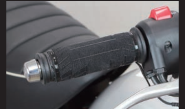
モンキー125 純正アクセサリソケット、 シガーチャージャーを使用して装着
