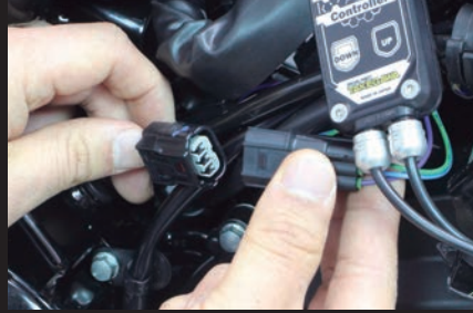
専用ハーネス付属により、配線加工の必要がなく、カプラーオンで簡単に取付け可能
