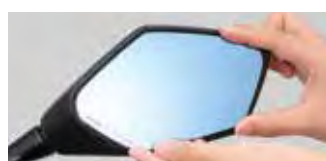
①ミラーに仮当てして貼り付け位置を確認
