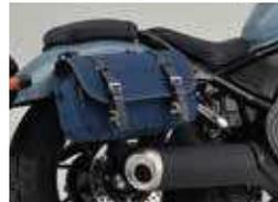
高さを低くすることでマフラー側への固定や左側に装着した際のバンク角を確保。(DHS-16/9Lのみ)
