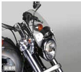
●縦216mm (センター部)×横235mm ●材質:ポリカーボネイト 板厚3mm ●表面処理:FMRハードコート ●フロントフォーク径φ44~51mm対応
