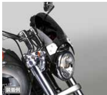
●縦216mm (センター部)×横235mm ●材質:ポリカーボネイト 板厚3mm ●表面処理:FMRハードコート ●フロントフォーク径φ44~51mm対応
