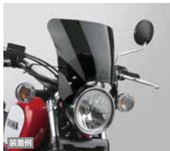
●縦235mm (センター部)×横298mm ●材質:ポリカーボネイト 板厚4.5mm ●表面処理:ハードコート処理 ●フロントフォーク径φ31~43mm対応
