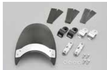
●縦216mm (センター部)×横235mm ●材質:ポリカーボネイト 板厚3mm ●表面処理:FMRハードコート ●フロントフォーク径φ44~51mm対応
