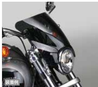
●縦235mm (センター部)×横298mm ●材質:ポリカーボネイト 板厚4.5mm ●表面処理:ハードコート処理 ●フロントフォーク径φ44~51mm対応
