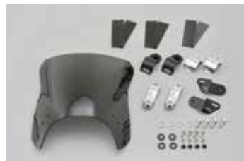
●縦235mm (センター部)×横298mm ●材質:ポリカーボネイト 板厚4.5mm ●表面処理:ハードコート処理 ●フロントフォーク径φ44~51mm対応
