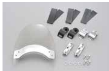
●縦216mm (センター部)×横235mm ●材質:ポリカーボネイト 板厚3mm ●表面処理:FMRハードコート ●フロントフォーク径φ44~51mm対応
