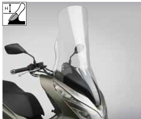
●H420mm×W394mm (Hはフロントカウルの上端からスクリーンの上端まで、Wは最も幅が広い場所) ●材質:ポリカーボネイト 板厚3mm ●表面処理:ハードコート処理
